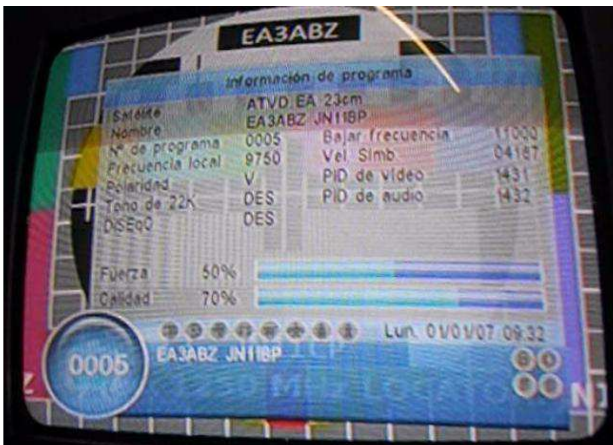
Fig 3. Ejemplo del setup receptor DVB-S.
