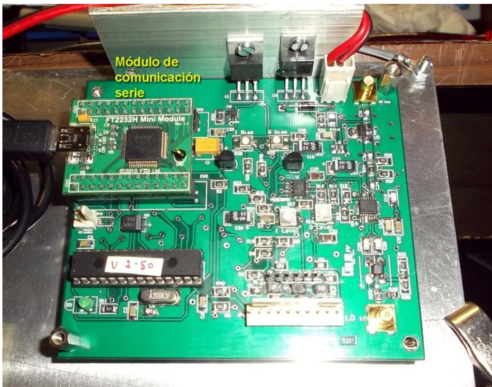
Fig.9. Cara superior DigiLite con el MiniModul conectado.
