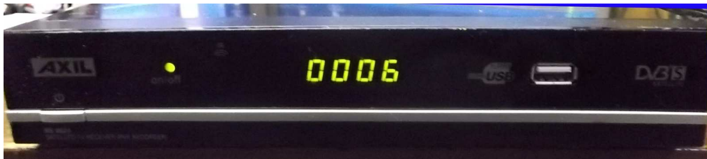
Fig. 2. Receptor tipo DV3Sat que usamos para recibir DATV.
